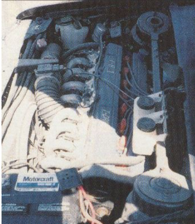
Motor de 8 cilindros en línea, DOHC, con transmisión T-Drive. Nótese el escaso espacio disponible una vez montado el conjunto motriz.
